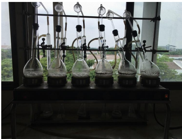
ภาพที่ 3.5 การวิเคราะห์ปริมาณไนเตรทไนโตรเจน ( \text{NH}_3\text{-N} )
