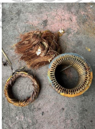
ภาพที่ 31 ชิ้นส่วนจากการถอดแยกมอเตอร์
