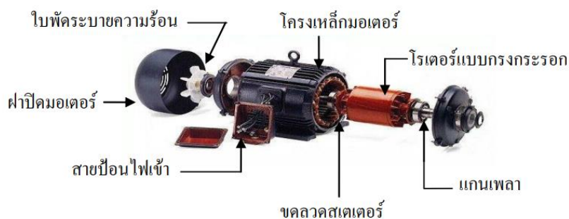
ภาพที่ 14 โครงสร้างภายในมอเตอร์ไฟฟ้าเหนี่ยวนำ 3 เฟส โรเตอร์แบบกรงกระรอก
