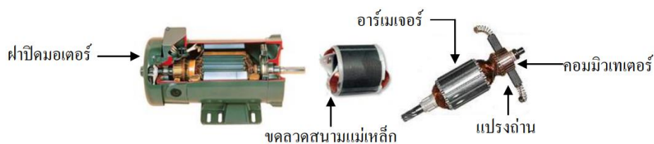
ภาพที่ 10 โครงสร้างภายในของยูนิเวอร์แซลมอเตอร์
