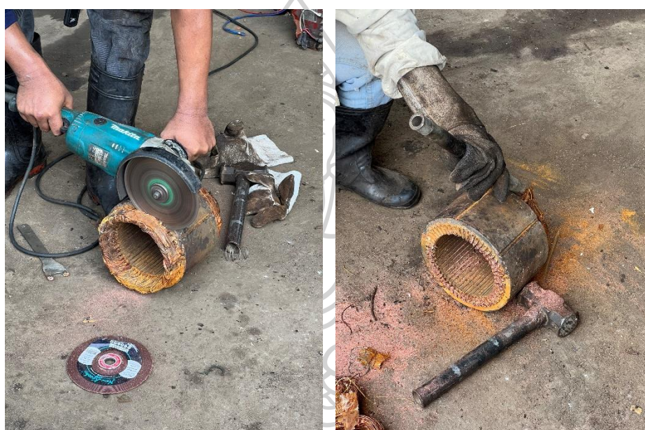
ภาพที่ 30 การถอดแยกขยะมอเตอร์
