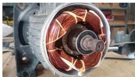
ขดลวดรันและขดลวดสตาร์ที่พันในร่องสลอต
