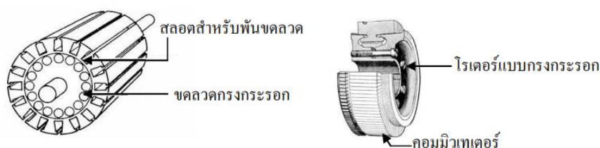
ภาพที่ 12 โครงสร้างของโรเตอร์ที่มีตัวนำกรงกระรอกซ้อนไว้ภายใน
