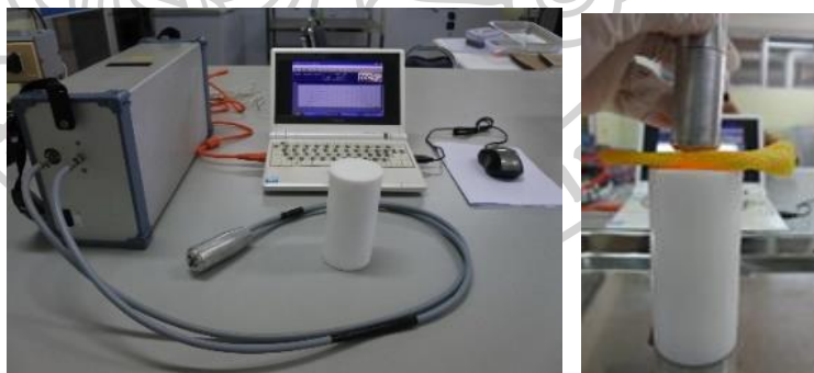
ภาพที่ 6 การวัดสเปกตรัมการดูดกลืนของตัวอย่างผักและผลไม้อบแห้งด้วยเครื่อง portable vis/NIR spectrometer
