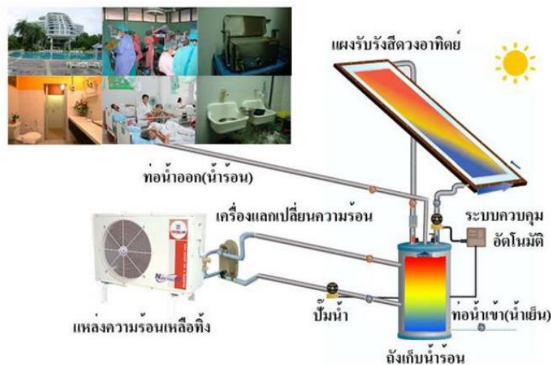
รูปที่ 2.8 เครื่องทำน้ำร้อนพลังงานแสงอาทิตย์ชนิดผสมผสาน
