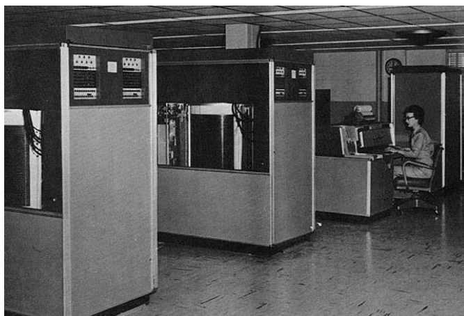
รูปที่ 2.6 ฮาร์ดดิสก์ไดรฟ์ RAMAC ที่ผลิตขึ้นโดยบริษัทไอบีเอ็ม
