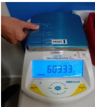
ภาพที่ 44 การประทับลายนิ้วมือบนถุงพลาสติก ใช้แรงกดให้มีน้ำหนักประมาณ 500-800 g ค้างไว้เป็นเวลา 3-5 s
