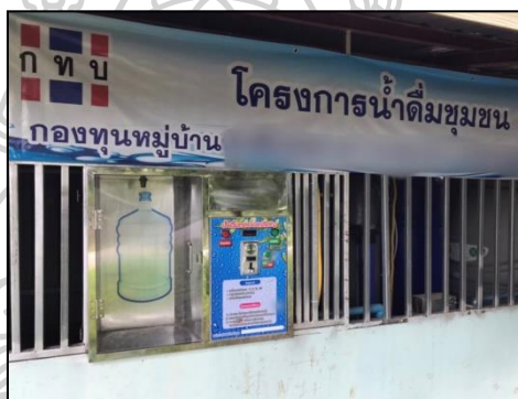
ภาพที่ 3 ตู้น้ำดื่มหยอดเหรียญอัตโนมัติรูปแบบที่หนึ่ง ชนิดมีช่องสำหรับจ่ายน้ำ อาจมีหรือไม่มีประตูเปิด-ปิด
