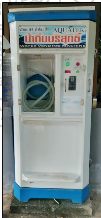
ภาพที่ 7 ตู้น้ำดื่มหยอดเหรียญอัตโนมัติที่มีการติดตั้งสายยางและจัดเก็บเต็มพื้นที่ช่องจ่ายน้ำ
