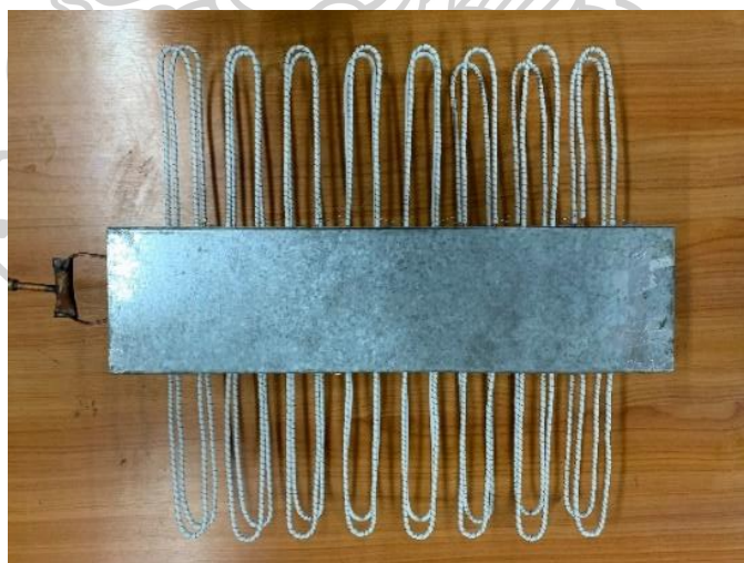
รูปที่ 3.23 แสดงการประกอบกล่องสังกะสีเข้ากับท่อความร้อน
