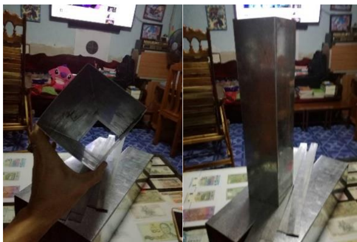
รูปที่ 3.20 แสดงการพับแผ่นสังกะสีเพื่อประกอบเข้ากับท่อความร้อน
