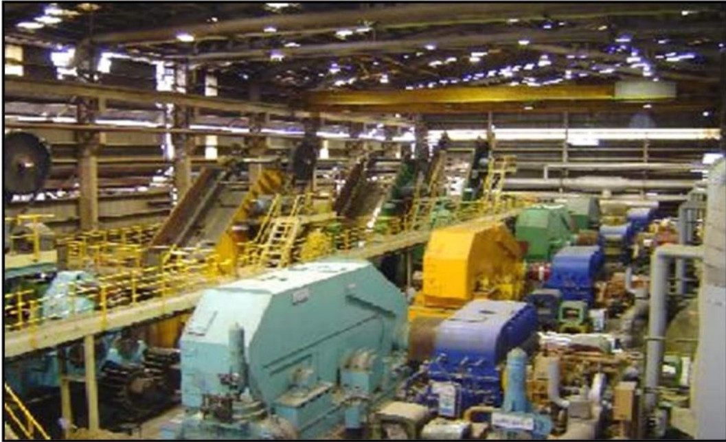
รูปที่ 18 เครื่องจักรที่ใช้ในการหีบสกัดน้ำอ้อย
