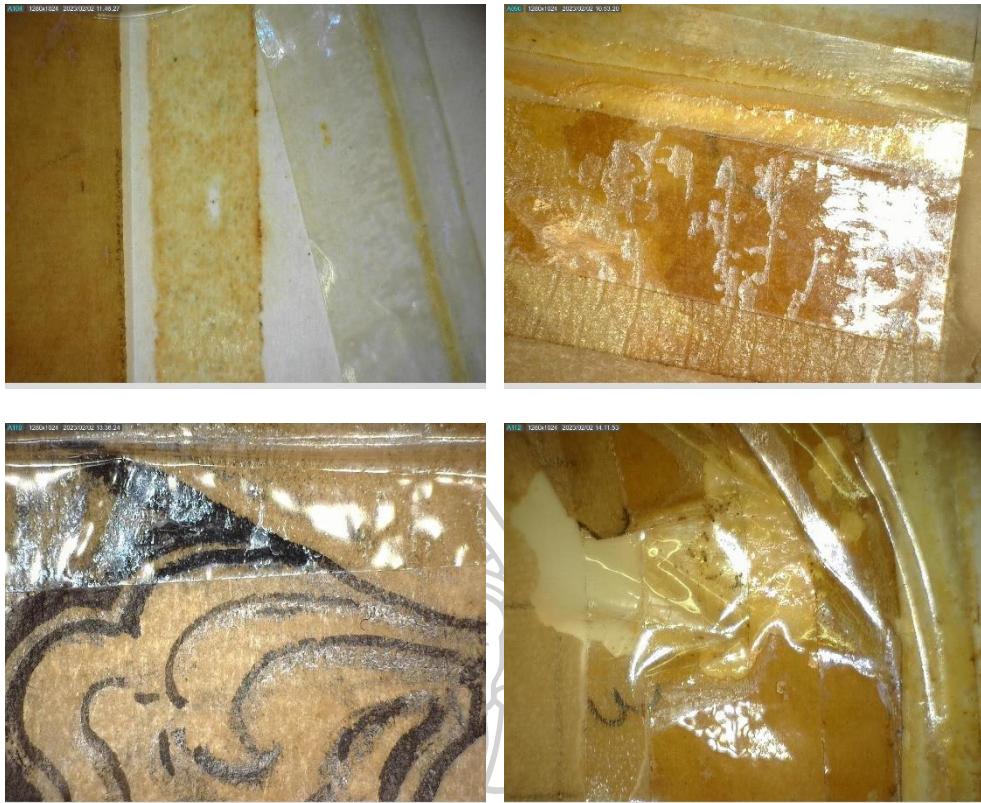
ภาพที่ 17 ปัญหาของเทปกาวจากตัวอย่างชิ้นงานที่ 1 โดยกล้องจุลทรรศน์ดิจิทัล
