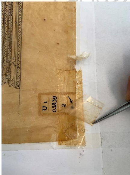
ภาพที่ 70 ขั้นตอนการใช้สเปตุลุ่มสอดกลางระหว่างเทปกาวและกระดาษ
