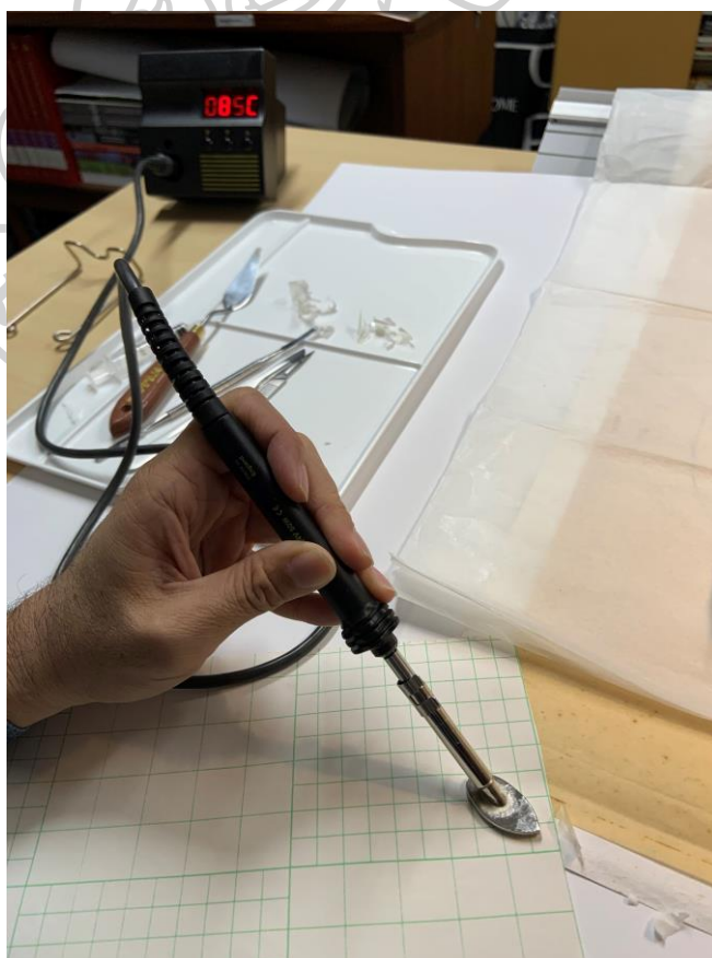
ภาพที่ 55 นำเครื่องมือปากกาให้ความร้อนประมาณ 85°C วางทาบลงบนแผ่นซิลิโคนลีส
