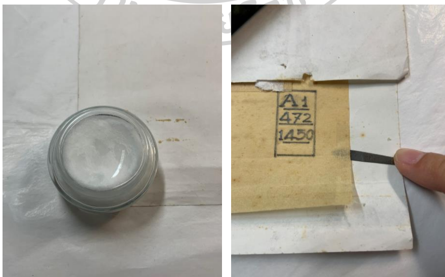
ภาพที่ 58 ให้ไอระเหยตัวทำละลาย (solvent A : Ethanol + ACETONE) ใส่ในฝาขวดแก้วปิดครอบทับเทปกาวย่น
