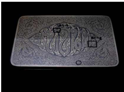
ภาพที่ 36 การกำหนดจุดบนแผ่นพลาสติกใสเพื่อทดสอบเจลทำความสะอาด
