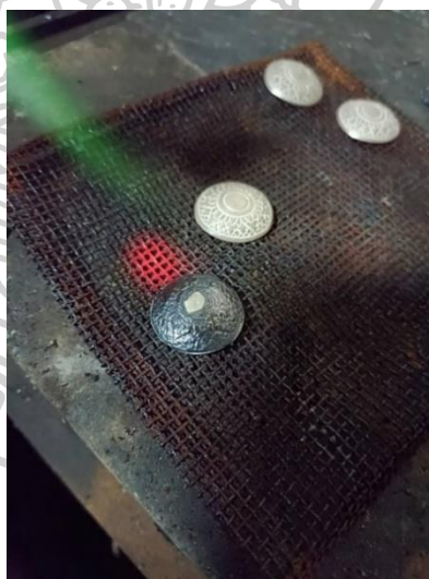
ภาพที่ 24 การใช้ไฟเพื่อละลายยามถมบนชิ้นงานเงิน
