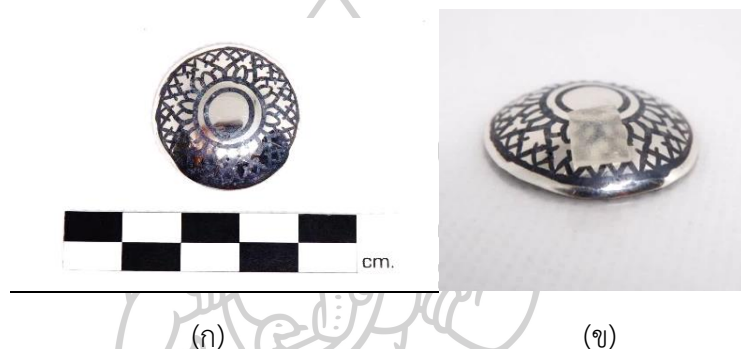
ภาพที่ 49 ชิ้นงานทดลองก่อนและหลังทำความสะอาด เหรียญที่เกิดสนิม (ก) ก่อนและ (ข) หลังทำความสะอาดด้วยไฮโดรเจล
