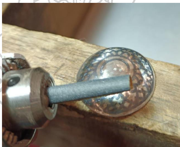
ภาพที่ 26 การขัดยาถมด้วยกระดาษทราย
