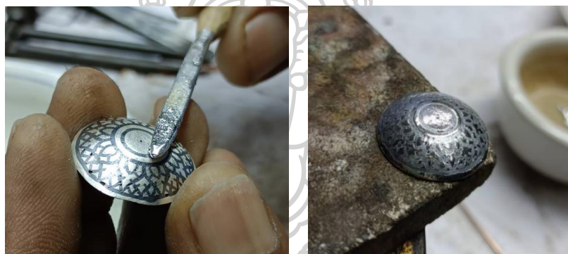
ภาพที่ 32 การทาทองให้ทั่วชิ้นงานโดยใช้แท่งเหล็ก
