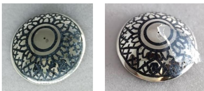
ภาพที่ 41 เครื่องถมเงินจำลองที่เกิดสนิม
