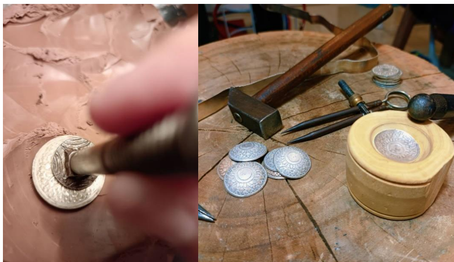
ภาพที่ 21 การโอบชิ้นงานให้มีความเว้าความนูนตามต้องการ
