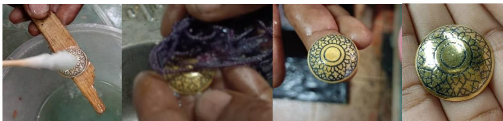
ภาพที่ 34 การทำความสะอาดถมทอง
