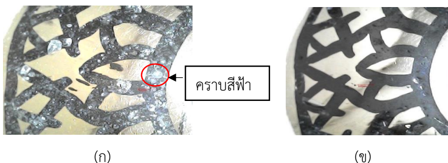
ภาพที่ 50 ภาพตัวอย่างเครื่องเงินที่ทำขึ้นใหม่ (ก) ก่อน และ (ข) หลัง การทำความสะอาดด้วยไฮโดรเจล
