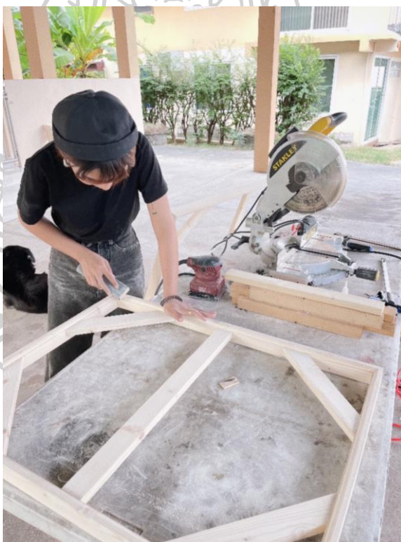
ภาพที่ 20 กระบวนการสร้างโครงเฟรมสำหรับชิงผ้าใบ
