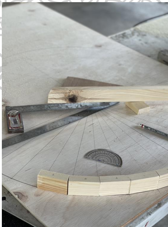
ภาพที่ 22 กระบวนการสร้างโครงเฟรมสำหรับชิงช้าใบ ที่มา : ผู้สร้างสรรค์
