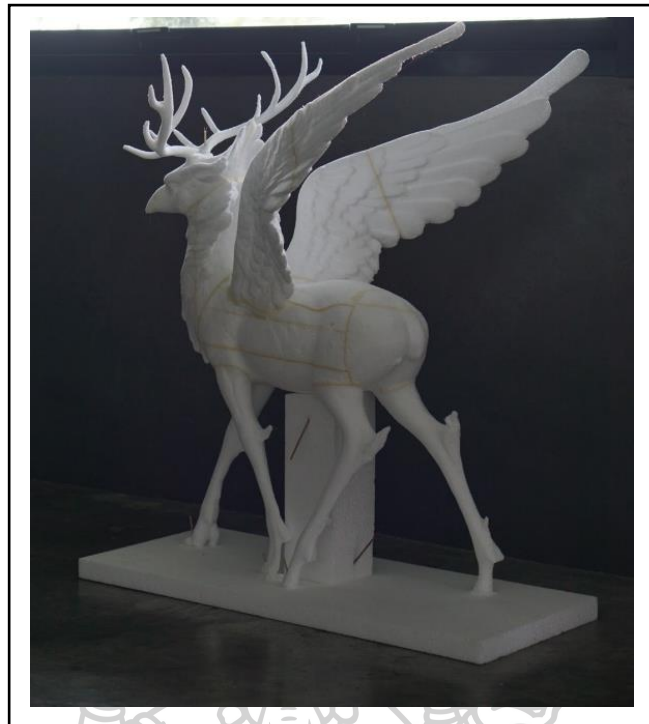
ภาพที่ 21 โฟมที่สแกนออกมาแล้วเป็นรูปแบบ 3 มิติ กริปโป no.1
