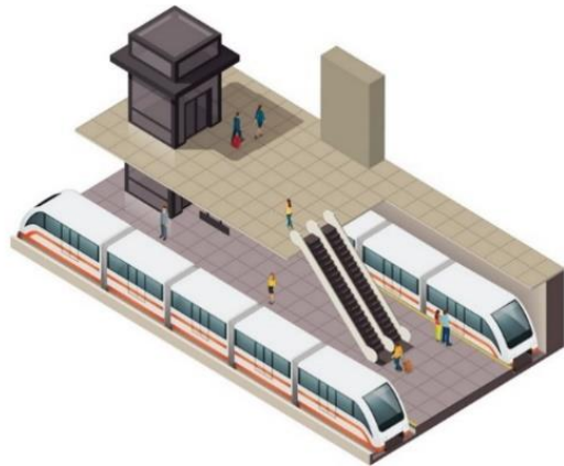
ภาพที่ 3 รูปแบบชานชาลากลาง ที่มา: การรถไฟฟ้าขนส่งมวลชนแห่งประเทศไทย, 2561
