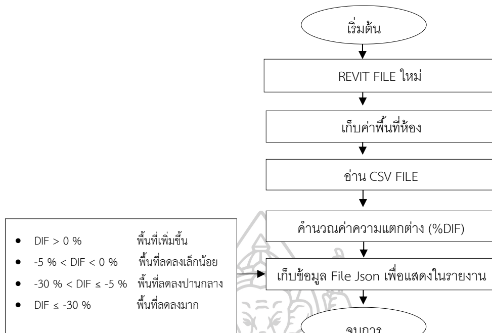
ภาพที่ 44 แผนผังการทำงานของโปรแกรมตรวจสอบพื้นที่ของห้อง
