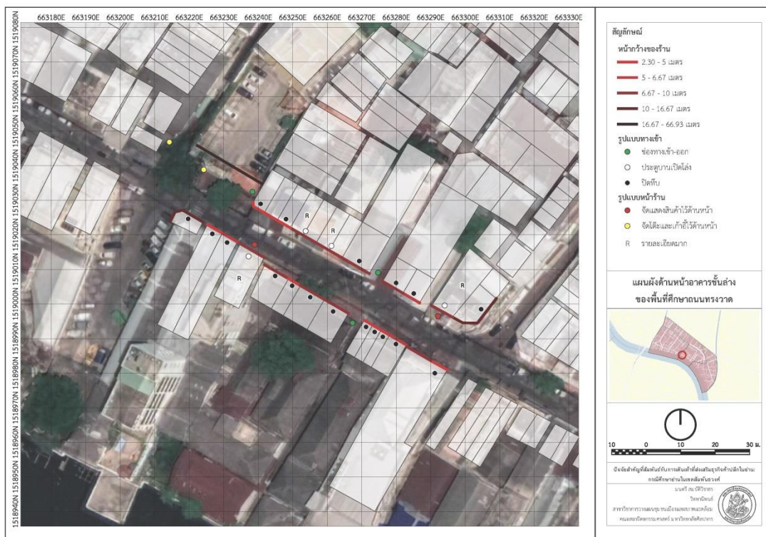
รูปที่ 91 คุณลักษณะของสภาพด้านหน้าอาคารชั้นล่างในพื้นที่ศึกษาถนนทรงวาด
