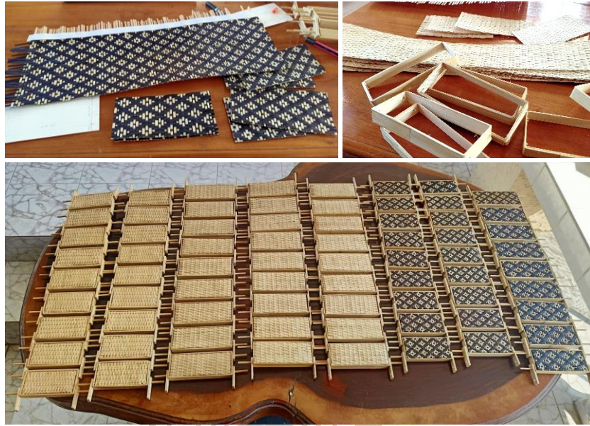
ภาพที่ 73 ตัดลายและประกอบสายพาน
