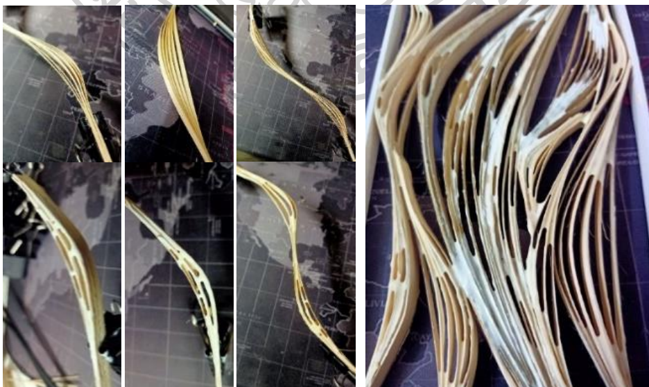
ภาพที่ 39 ทดลองซ้อนเส้นตอกแล้วผสานกันด้วยยางพารา
