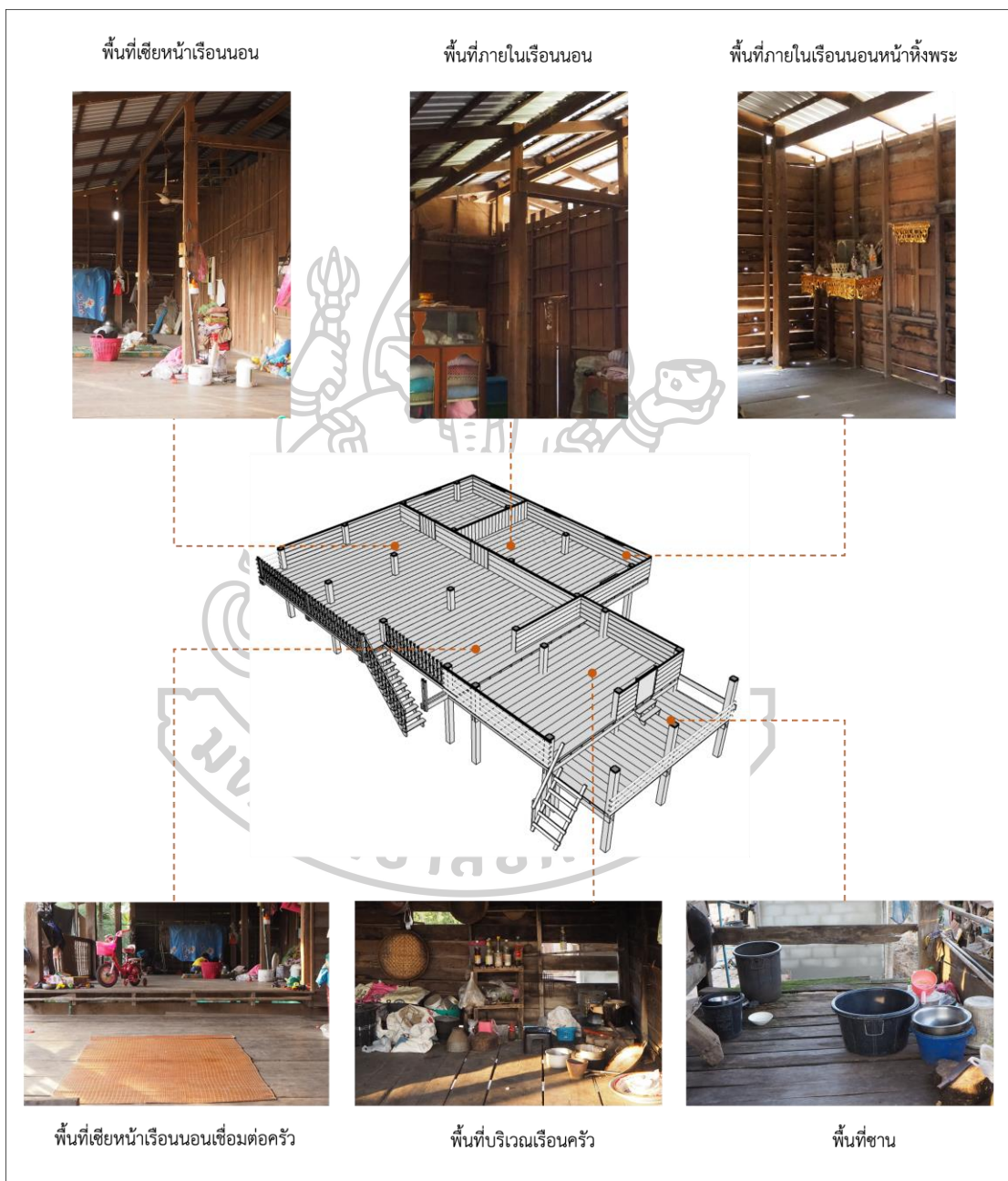
ภาพที่ 89 แสดงลักษณะพื้นที่ภายในเรือนกรณีศึกษาที่ 14 (T-DM-03)
