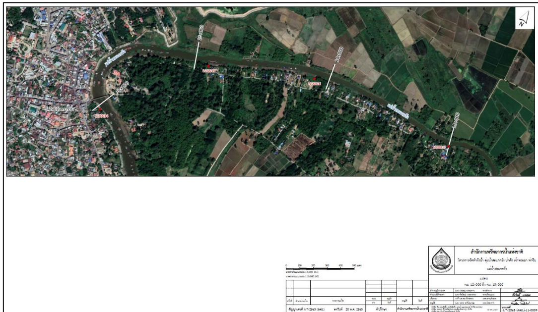
ภาพที่ 6 แสดงจุดสำรวจหน้าตัดลำน้ำสะแกกรัง ระหว่าง กม. 12+000 ถึง กม. 15+000
