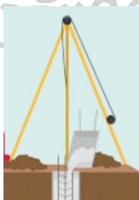
ภาพที่ 22 ขั้นตอนที่ 4 ในกระบวนการก่อสร้างเสาเข็มเจาะแบบแห้ง ที่มา : (ช่างมันส์, 2560)
