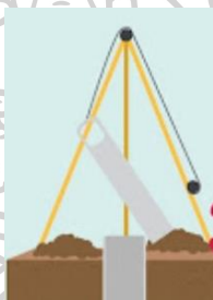
ภาพที่ 21 ขั้นตอนที่ 3 ในกระบวนการก่อสร้างเสาเข็มเจาะแบบแห้ง ที่มา : (ช่างมันส์, 2560)
