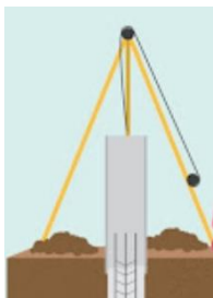
ภาพที่ 23 ขั้นตอนที่ 5 ในกระบวนการก่อสร้างเสาเข็มแบบแห้ง ที่มา : (ช่างมันส์, 2560)
