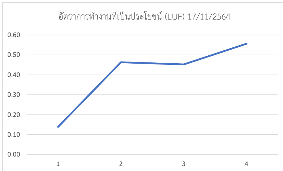
ภาพที่ 47 อัตราส่วนการทำงานที่เป็นประโยชน์ของงานเทคอนกรีตเสา ชั้น 1
