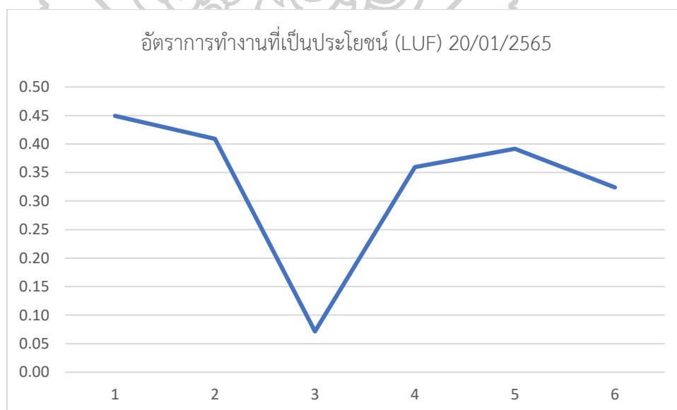
ภาพที่ 49 อัตราส่วนการทำงานที่เป็นประโยชน์ของงานเทคอนกรีตคาน ชั้น 2
