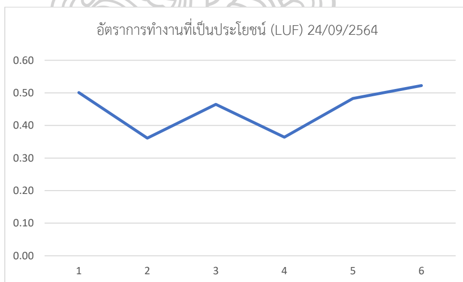
ภาพที่ 43 อัตราส่วนการทำงานที่เป็นประโยชน์ของงานเทคอนกรีตคาน ชั้น 1
