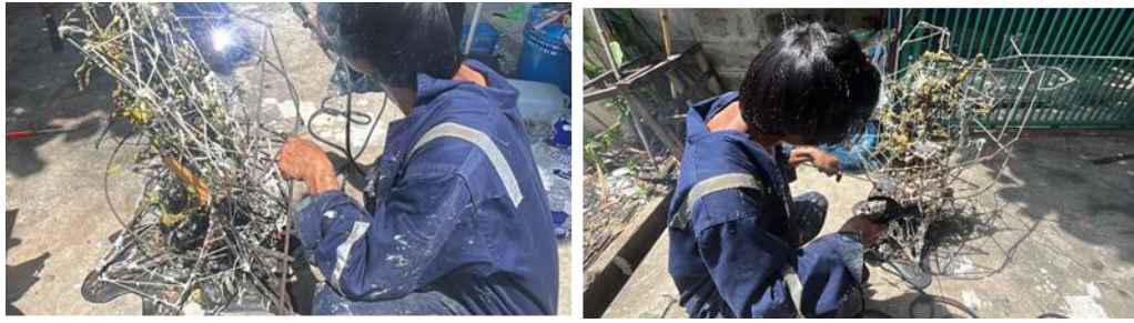
ภาพที่ 135 ขั้นตอนการ เชื่อมโครงสร้างแบบกำหนดทิศทางแสงเงา 2
