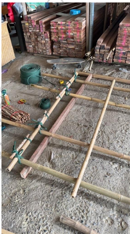
ภาพที่ 98 : การนำไม้ไผ่มาจัดวาง ก่อนขึ้นรูปทรง แหล่งที่มา : ผู้วิจัย ณิชพิสิษฐ์ พลับขจร (ถ่ายเมื่อวันที่ 15/8/2566)
