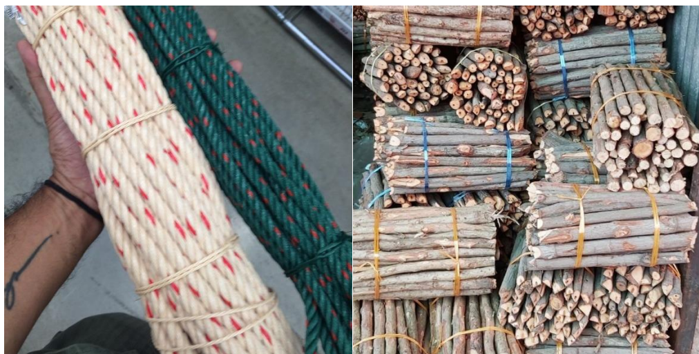
ภาพที่ 100 : วัสดุที่ใช้ในการมัดไม้ไผ่ เชือกไนลอน และไม้ชั้นชะเนาะ แหล่งที่มา : https://kaimaipai.com/th/products/520711 (สืบค้นเมื่อวันที่ 5/3/2566)
