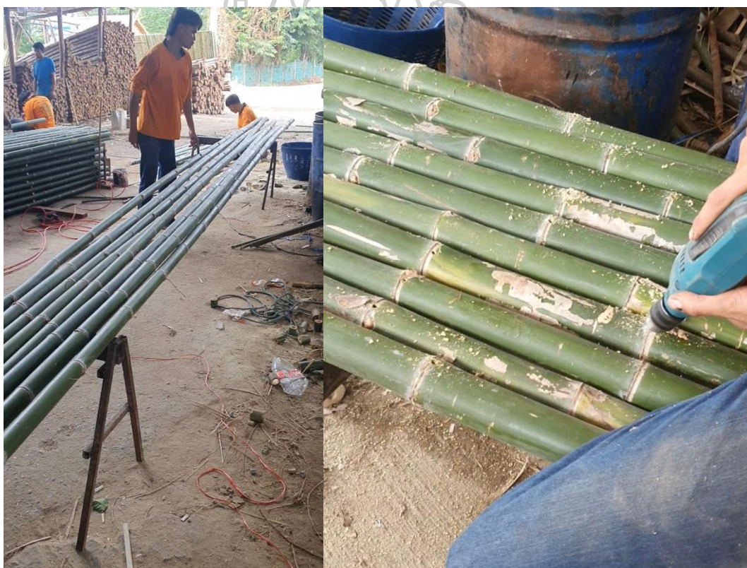
ภาพที่ 94 : การเจาะรูไม้ไผ่ เพื่อแช่น้ำยา
