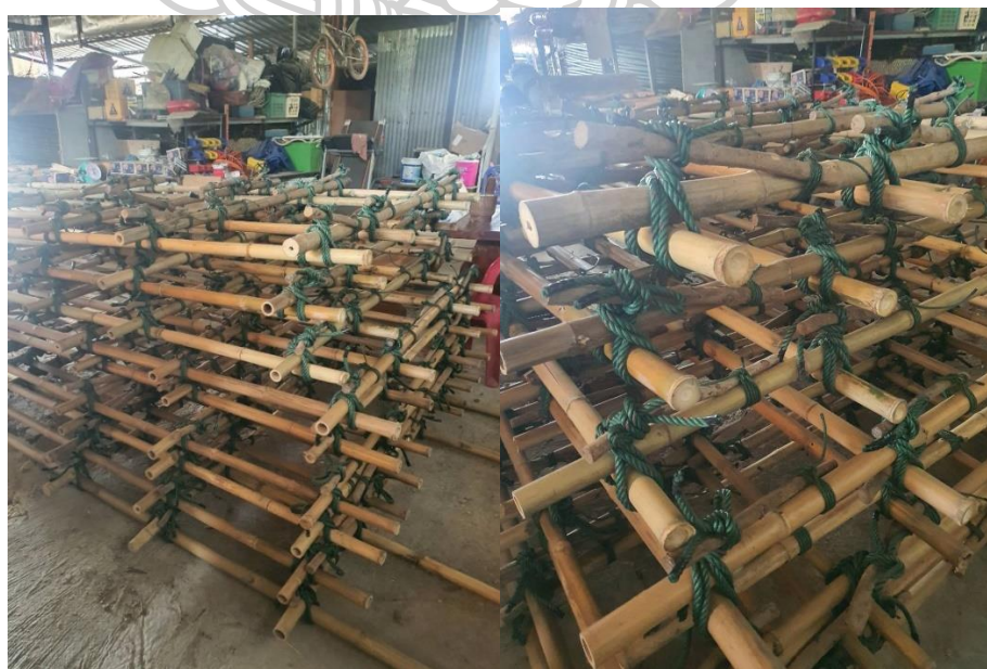
ภาพที่ 103 : ลักษณะของการจัดเรียงไม้ไผ่เพื่อที่จะทำการประกอบเป็นรูปทรง 3 มิติ แหล่งที่มา : ผู้วิจัย อนุรักษ์สิษฐ์ พลับขจร (ถ่ายเมื่อวันที่ 15/8/2566)
