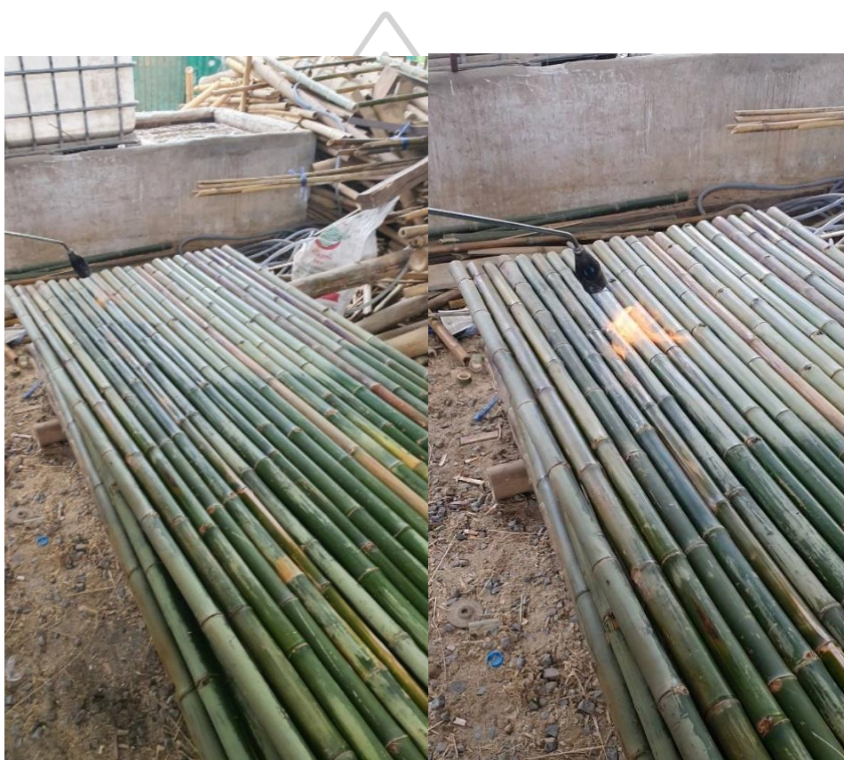
ภาพที่ 97 : ลักษณะการตากแห้งและการใช้ไฟเร่งให้ไม้ไผ่แห้งไวขึ้น แหล่งที่มา : ผู้วิจัย ธีรวิศิษฐ์ พลับขจร (ถ่ายเมื่อวันที่ 15/8/2566)
