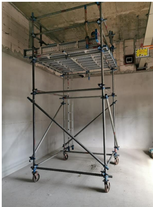
ภาพที่ 34 : แสดงรูป นั่งร้านแบบชนิดเคลื่อนที่ได้ แหล่งที่มา : https://tk21.co.th/product/ (สืบค้นเมื่อวันที่ 5/3/2566)
