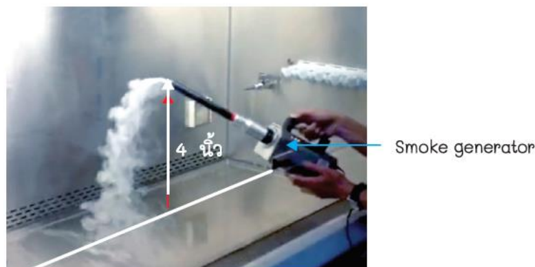
รูปที่ 41 (รูปผนวก ข.8) Smoke test จุดที่ 1 ดูทิศทางการไหลของลมผ่านไปยังพื้นที่ทำงาน ที่มา : สุขใจ ผลอำไพสถิตย์ และอรอนงค์ รัชตราเซนชัย (2557). คู่มือการใช้ตู้ชีวนิรภัยอย่าง ถูกต้องปลอดภัย. โรงพิมพ์สำนักงานพระพุทธศาสนาแห่งชาติ : หน้า 45.
