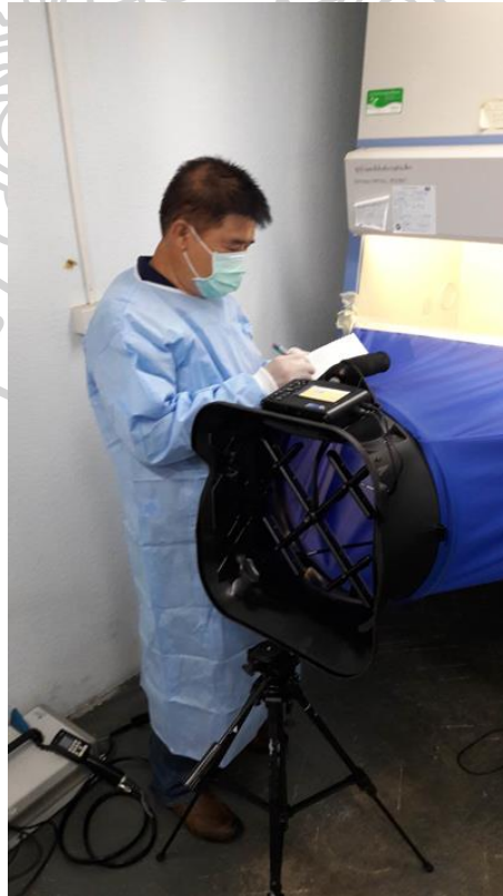
รูปที่ 38 (รูปผนวก ข.5) การวางอุปกรณ์ Dim with hood ครอบช่องหน้าต่างด้านหน้าตู้
