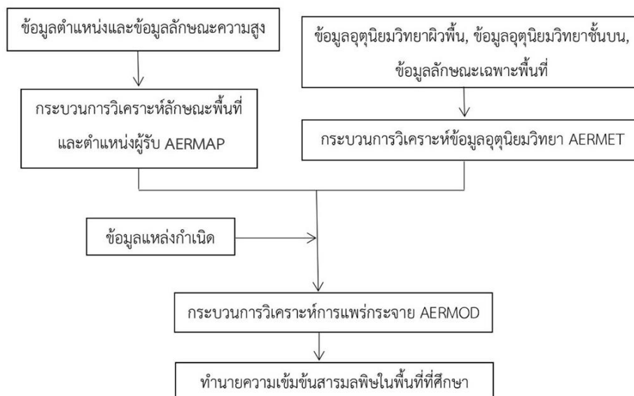
ภาพที่ 4 โครงสร้างการทำงานของแบบจำลองคุณภาพอากาศ AERMOD ที่มา: ดัดแปลงจาก วราวุธ เสือดี (2550)
