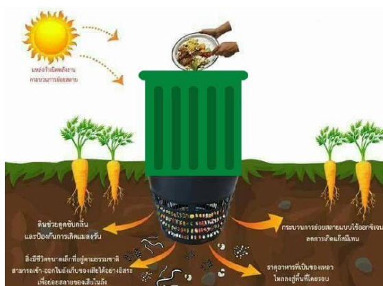
ภาพที่ 2.4 ปุ๋ยหมักแบบตะกร้าฝังดิน (Green Cone)
