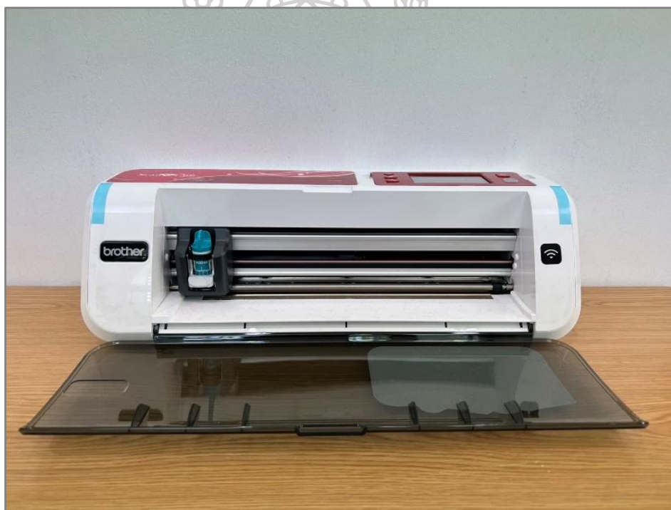
ภาพที่ 78 เครื่อง Scan and Cut brother CM700 สำหรับการตัดกระดาษตามขนาดต้นแบบ
