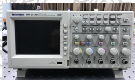
รูปที่ 46 เครื่องแสดงรูปคลื่นสัญญาณไฟฟ้า
