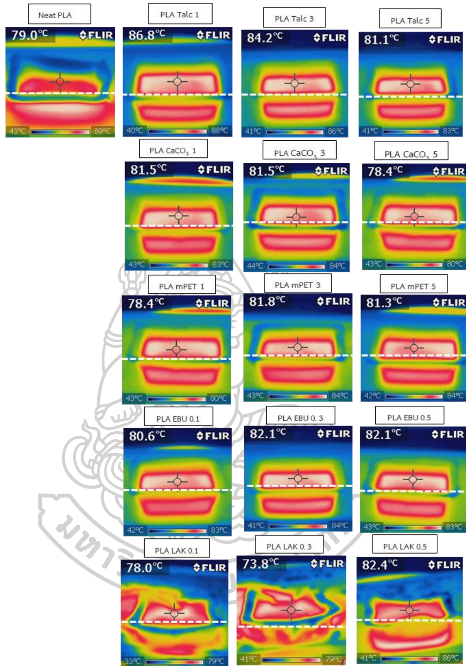
รูปที่ 38 ภาพถ่ายจากการทดสอบด้วย FLIR temperature sensor ที่การทดสอบด้วยไมโครเวฟที่ เต็มน้ำ โดยทำการทดสอบกำลังไฟฟ้าที่ 600 วัตต์ที่เวลา 3.5 นาที ของ Neat PLA และ PLA ที่ผ่านการปรับปรุงสมบัติด้วยสารตัวเติม Talc CaCO 3 และ mPET และสารก่อผลึก LAK และ EBU
