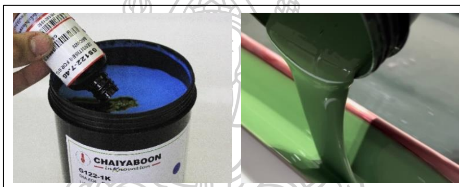
ภาพที่ 38 ภาพแสดงขั้นตอนการผสมกาวอัดกับน้ำยาไวแสง และเทกาวอัดลงบนรางปาด ที่มาภาพ: ผู้วิจัยสร้างสรรค์
