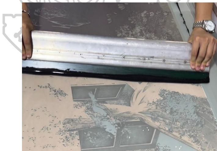
ภาพที่ 50 ภาพแสดงขั้นตอนการดันยางปาดเพื่อเคลือบบล็อกสกรีน ที่มาภาพ: อภิสิทธิ์ ชูณรงค์
