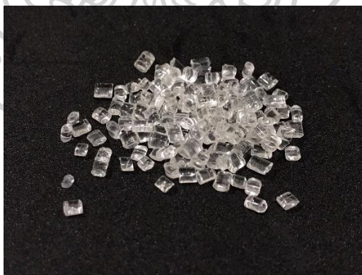
ภาพที่ 46 พาราลอยด์ B-44 ในรูปแบบเม็ด (ผลิตโดย The Dow Chemical Company)
