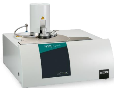
ภาพที่ 61 เครื่องวิเคราะห์ความหนาแน่นของน้ำหนักตามอุณหภูมิ Thermal Gravimetric Analyzer (TGA)
