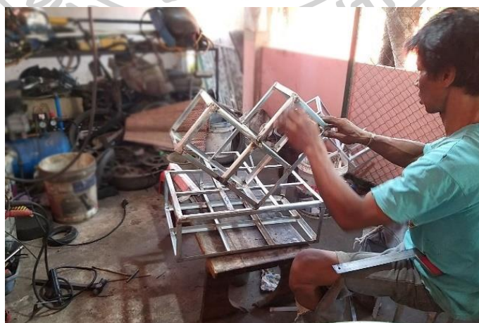
ภาพที่ 109 ช่างกำลังเชื่อมโครงเหล็กเพื่อสร้างตัวอักษร ที่มา: ภาพถ่ายโดย ธนธร สรรพกิจจานง
