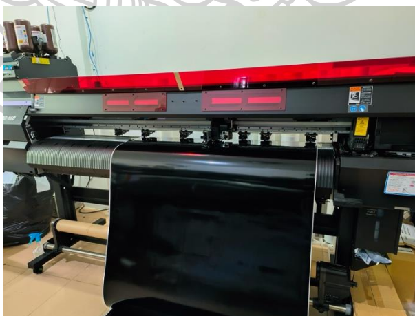
ภาพที่ 219 การตัดแผ่นสติ๊กเกอร์จากเครื่องตัดสติ๊กเกอร์อุตสาหกรรม ที่มา: ภาพถ่ายโดย ธนธร สรรพกิจจำนง
