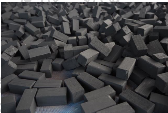
ภาพที่ 216 ถ่านไม้สนที่ถูกตัดขนาด 1:2 ที่มา: ภาพถ่ายโดย ธนธร สรรพกิจจำนง
