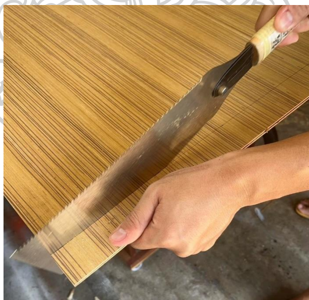
ภาพที่ 13 การขึ้นรูปกล่องไม้วัสดุไม้สักและไม้กระดาน ที่มา ภาพถ่ายโดยผู้สร้างสรรค์
