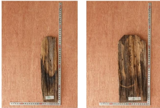
ภาพที่ 3.52 ความหลากหลายของขนาดแผ่นหลังคาเป็นเกล็ดแบบดั้งเดิม กลุ่มตัวอย่างทดลอง Old
