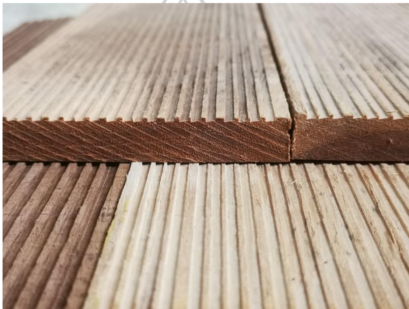
ภาพที่ 5.1 ไม้แป้นเกล็ดแบบผสมผสาน ไซ้ร่อง 2.2 มม. ลึก 1 มม.
