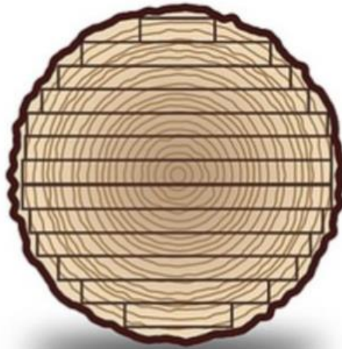
ภาพที่ 2.4 การเลื่อยไม้เป็นแผ่นแบบ Plain sawn หรือ Flat sawn อ้างอิง https://www.timbertown.com/flat-sawn-vs-quarter-sawn-lumber/ 2566
