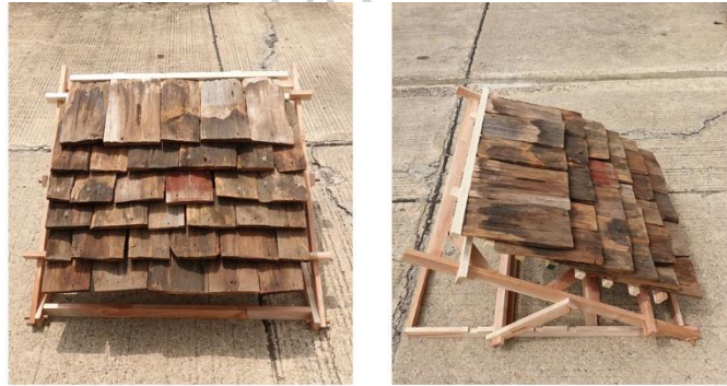
ภาพที่ 3.69 แบบจำลองเพื่อทดลองการไหลผ่านของน้ำบนหลังคา รหัส Old 20°
