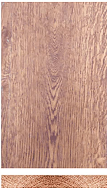
ภาพที่ 2.5 ลายเส้นที่หน้าไม้ และหน้าตัดไม้จากวิธีการเลื่อยไม้เป็นแผ่นแบบ Plain sawn หรือ Flat sawn
