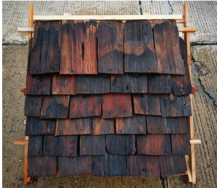
ภาพที่ 4.5 การทดสอบจำลองฝนตกบนหลังคาแป้นเกล็ดแบบดั้งเดิมที่มีความลาดเอียง 30° รหัส Old 30°
