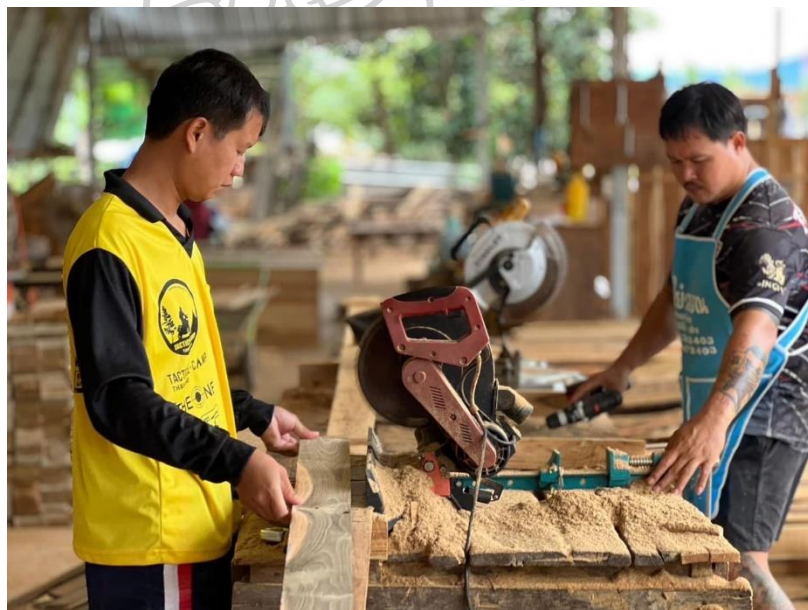
ภาพที่ 3.36 การสับไม้ให้ได้ขนาดตามความยาวของแผ่นหลังคาเป็นเกล็ด
