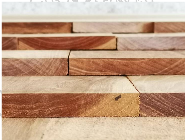
ภาพที่ 4.14 รูปด้านหน้าตัดของแผ่นแป้นเกล็ดไม้สักแบบประยุกต์ มองเห็นช่องว่างระยะห่างของแผ่น
