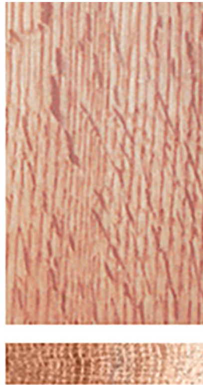
ภาพที่ 2.7 ลายเส้นที่หน้าไม้ และหน้าตัดไม้ที่แปรรูปเป็นแผ่นด้วยวิธีการแบ่งหน้าตัด 4 ส่วน แบบ Quarter sawn
