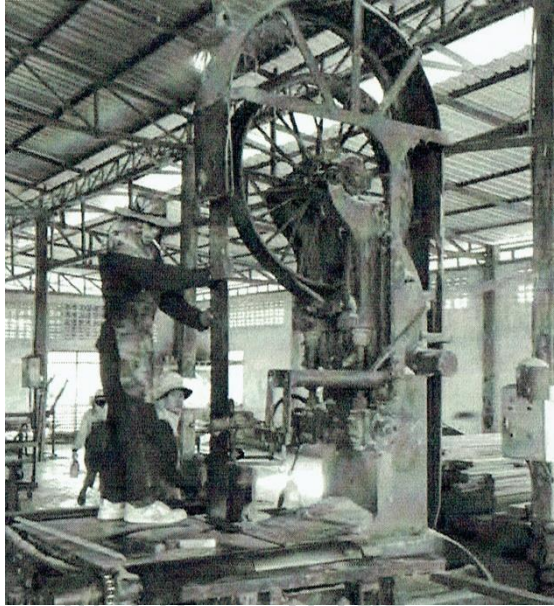
ภาพที่ 2.14 เลื่อยสายพานแบบตั้ง ใช้ในงานอุตสาหกรรม สันฐาน เวียงสีมา (2563b)
