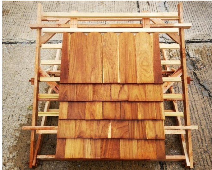
ภาพที่ 4.9 การทดสอบจำลองฝนตกบนหลังคาเป็นเกล็ดแบบประยุกต์ที่มีความลาดเอียง 30° รหัส Old 30°
