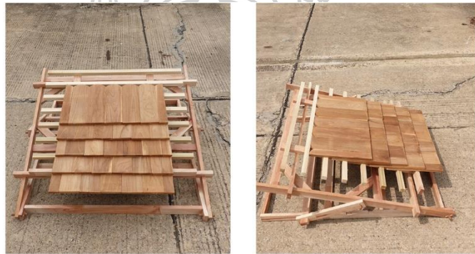
ภาพที่ 3.73 แบบจำลองเพื่อทดลองการไหลผ่านของน้ำบนหลังคา รหัส New 20°
