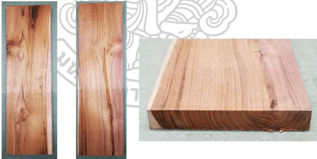
ภาพที่ 4.25 รูปด้านหน้า รูปด้านหลังแผ่นแป้นเกล็ด / หน้าตัดลายเส้นแบบลายภูเขาจากการแปรรูป รูปด้วยเครื่องมือแบบอุตสาหกรรม
