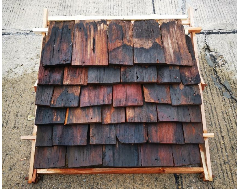
ภาพที่ 4.4 การทดสอบจำลองฝนตกบนหลังคาแป้นเกล็ดแบบดั้งเดิมที่มีความลาดเอียง 20° รหัส Old 20°
