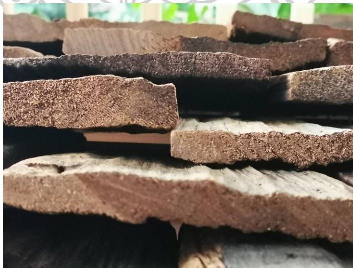
ภาพที่ 4.12 รูปด้านหน้าตัดของแผ่นแป้นเกล็ดไม้สักแบบดั้งเดิม มองเห็นช่องว่างระยะห่างของแผ่น
