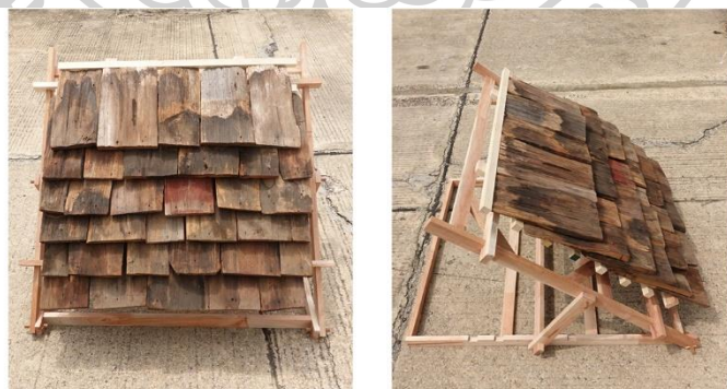
ภาพที่ 3.71 แบบจำลองเพื่อทดลองการไหลผ่านของน้ำบนหลังคา รหัส Old 40°
