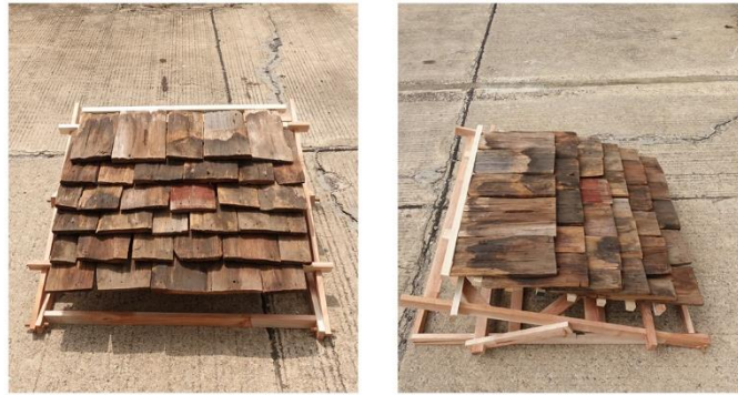
ภาพที่ 3.69 แบบจำลองเพื่อทดลองการไหลผ่านของน้ำบนหลังคา รหัส Old 20°
