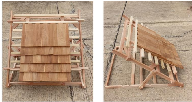
ภาพที่ 3.75 แบบจำลองเพื่อทดลองการไหลผ่านของน้ำบนหลังคา รหัส New 40°
