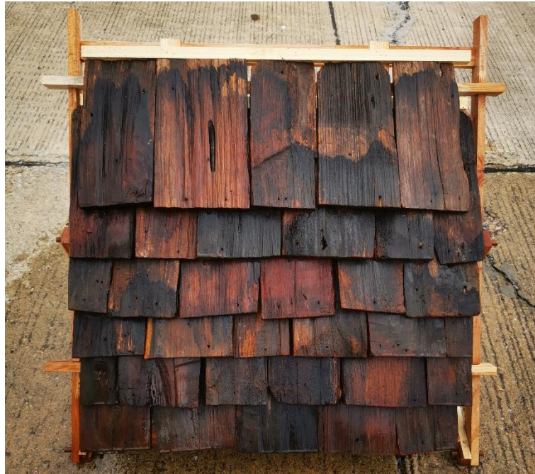
ภาพที่ 4.7 การทดสอบจำลองฝนตกบนหลังคาแป้นเกล็ดแบบดั้งเดิมที่มีความลาดเอียง 45° รหัส Old 45°
