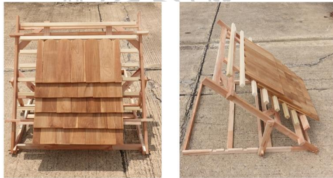
ภาพที่ 3.76 แบบจำลองเพื่อทดลองการไหลผ่านของน้ำบนหลังคา รหัส New 45°
