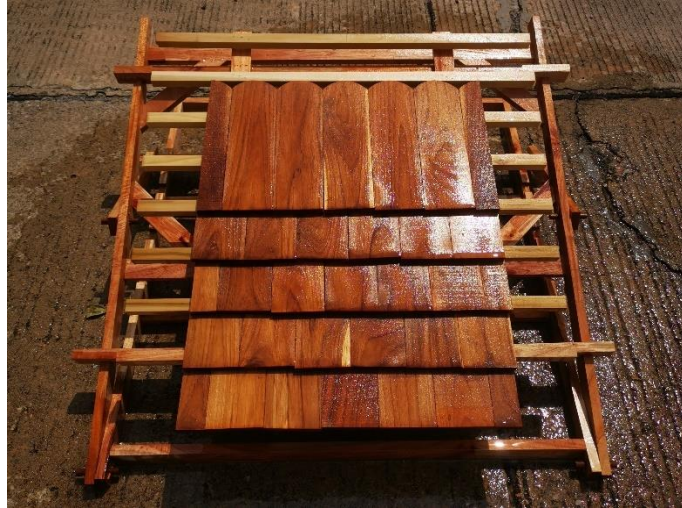
ภาพที่ 4.8 การทดสอบจำลองฝนตกบนหลังคาแป้นเกล็ดแบบประยุกต์ที่มีความลาดเอียง 20° รหัส Old 20°
