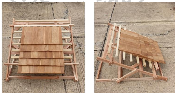
ภาพที่ 3.74 แบบจำลองเพื่อทดลองการไหลผ่านของน้ำบนหลังคา รหัส New 30°
