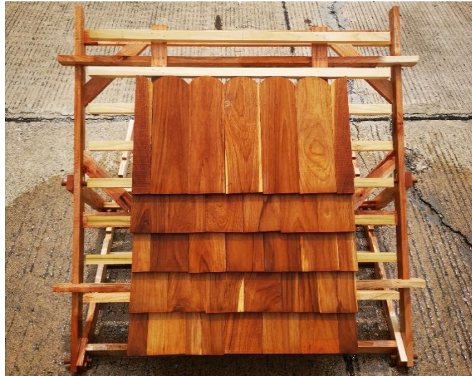
ภาพที่ 4.10 การทดสอบจำลองฝนตกบนหลังคาเป็นเกล็ดแบบประยุกต์ที่มีความลาดเอียง 40° รหัส Old 40°
