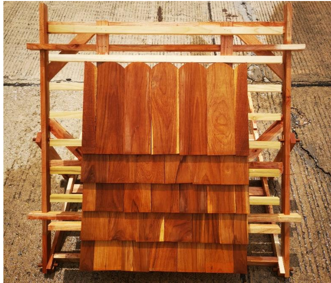
ภาพที่ 4.11 การทดสอบจำลองฝนตกบนหลังคาแบบเกล็ดแบบประยุกต์ที่มีความลาดเอียง 45° รหัส Old 45°
