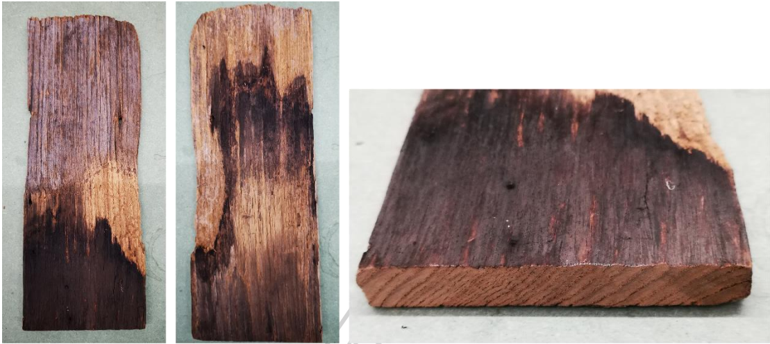
ภาพที่ 4.24 รูปด้านหน้า รูปด้านหลังแผ่นแป้นเกล็ด / หน้าตัดลายเส้นแบบลายเส้นจากการแปรรูป ด้วยเครื่องมือแบบดั้งเดิม
