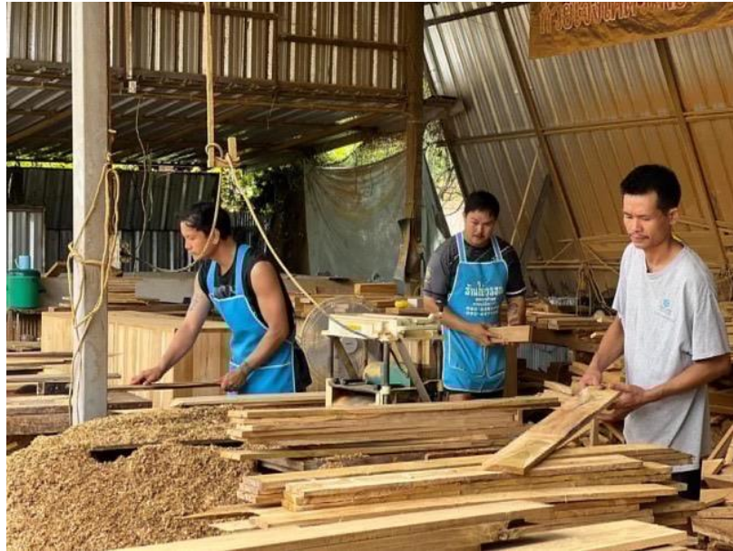
ภาพที่ 3.35 การปรับผิวไม้สักด้วยเครื่องรีดไม้ (แปรรูปไม้ด้วยวิธี Plain sawn)
