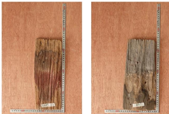
ภาพที่ 3.59 ความหลากหลายของขนาดแผ่นหลังคาเป็นเกล็ดแบบดั้งเดิม กลุ่มตัวอย่างทดลอง Old.
