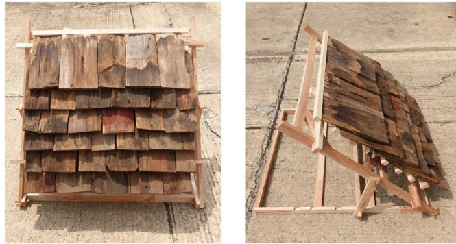
ภาพที่ 3.72 แบบจำลองเพื่อทดลองการไหลผ่านของน้ำบนหลังคา รหัส Old 45°
