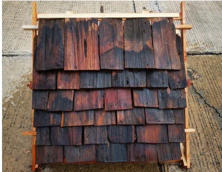
ภาพที่ 4.6 การทดสอบจำลองฝนตกบนหลังคาแป้นเกล็ดแบบดั้งเดิมที่มีความลาดเอียง 40° รหัส Old 40°
