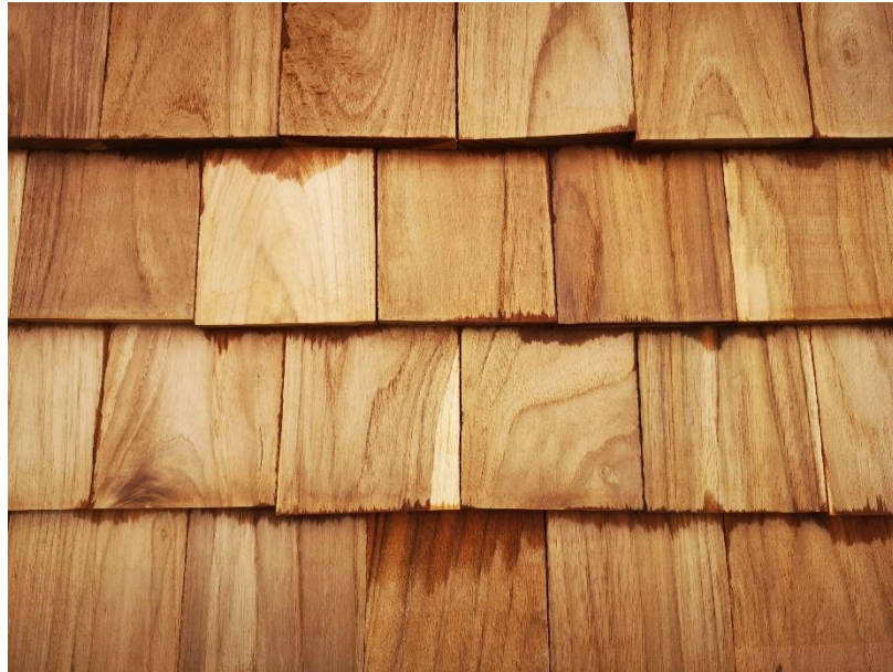
ภาพที่ 4.20 ความขึ้นบนผิวไม้แป้นเกล็ดที่ช่องว่างระหว่างแผ่นน้อย หลังผ่านไป 30 นาทีจากการฉีดน้ำ
