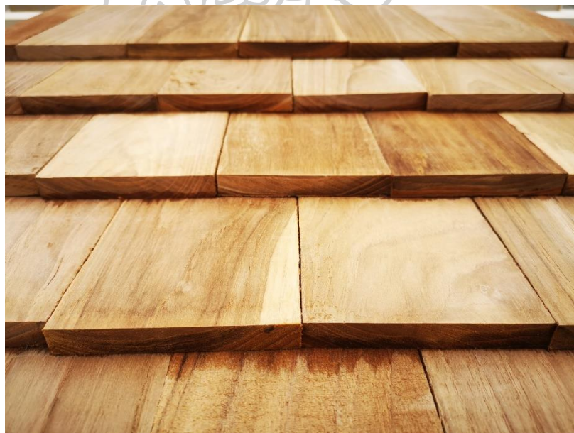
ภาพที่ 4.21 ความขึ้นบนผิวไม้แป้นเกล็ดที่ช่องว่างระหว่างแผ่นน้อย หลังผ่านไป 40 นาทีจากการฉีดน้ำ
