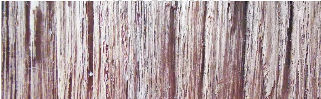
ภาพที่ 4.16 พื้นผิวแบบฉีก (Shakes) กลุ่มตัวอย่าง Old
