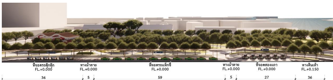
ภาพที่ 87 รูปตัดแสดงการปรับปรุงพื้นที่ Feeder บริเวณ พื้นที่จอดรถสามล้อรับจ้าง รถยนต์รับจ้าง สาธารณะ สองแถว ที่มา : ผู้ศึกษา, 2567
