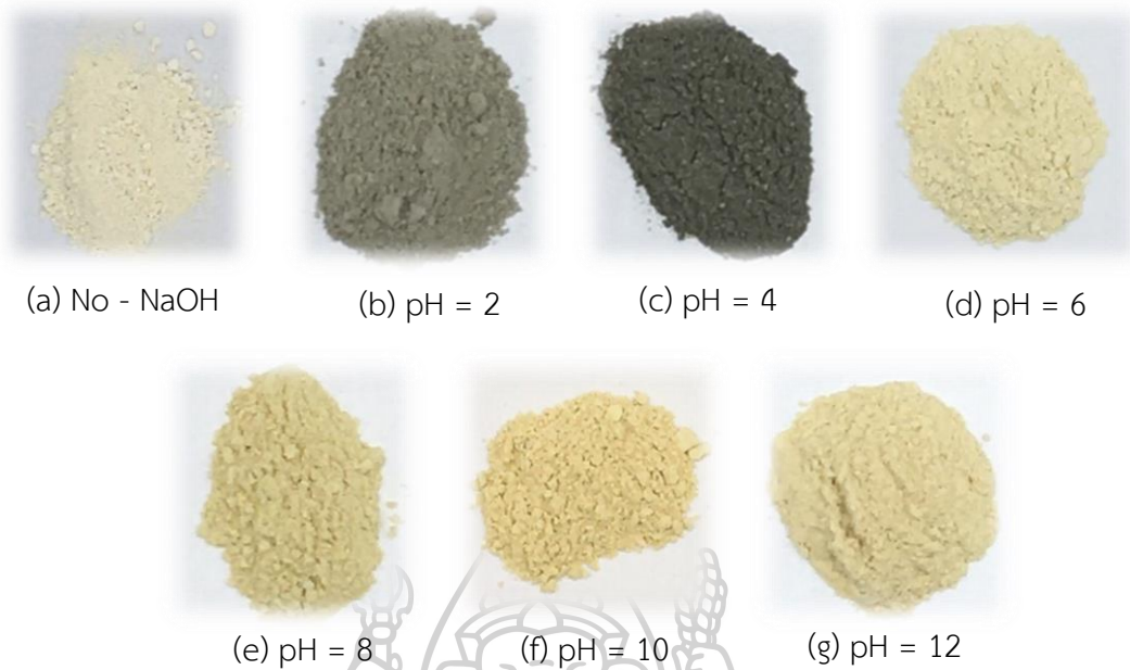
ภาพที่ 5 ลักษณะทางกายภาพของหินออกไซด์ที่แต่ละ pH โดยไม่ผ่านการเผา
