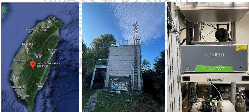
รูปที่ 46 ที่ตั้ง Lulin Atmospheric Background Station ของประเทศไต้หวัน และเครื่อง Picarro CO 2 /CH 4 ที่ใช้ในการวัดความเข้มข้นของคาร์บอนไดออกไซด์ ( http://lulin.tw/about )
