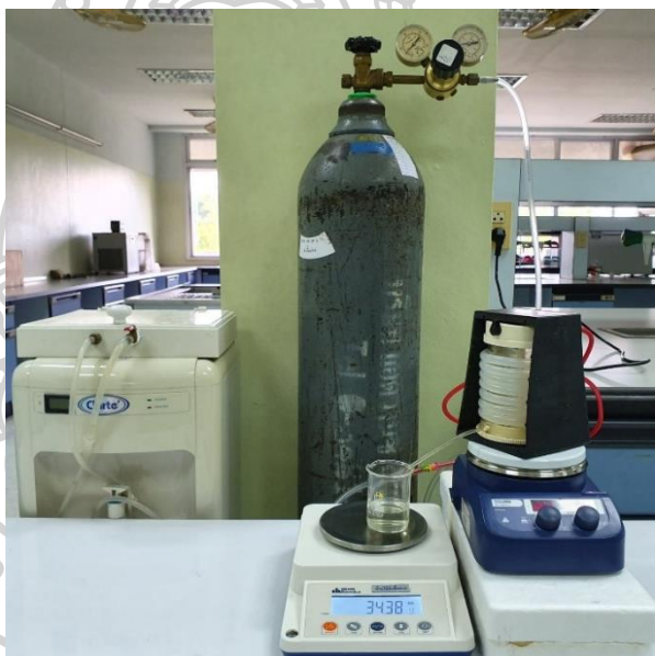
รูปที่ 7 ระบบการทำบริสุทธิ์โอลิโกแซคคาไรด์ด้วยอัลตราฟิลเตรชันที่อุณหภูมิ 13 \pm 1 องศาเซลเซียส
