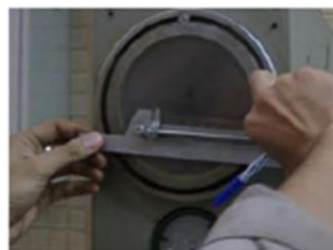
รูปที่ 2.18 วิธีการทดสอบแบบ Brinell [19]
