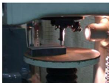
รูปที่ 2.18 วิธีการทดสอบแบบ Brinell [19]
