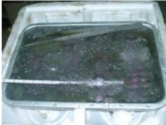
รูปที่ 2.13 การแช่ชิ้นงานทดสอบในน้ำแข็งเพื่อลดอุณหภูมิให้ต่ำกว่า 0 องศา [19]
