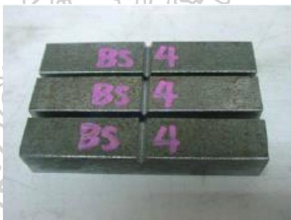
รูปที่ 2.12 ลักษณะของชิ้นงานทดสอบและรอยบากร่อง [19]
