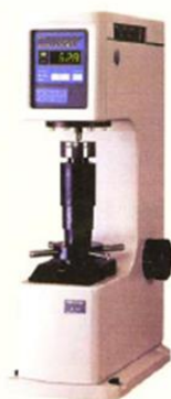
รูปที่ 2.20 วิธีการทดสอบแบบ Rockwell hardness test [19]
