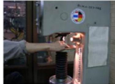
รูปที่ 2.17 การทดสอบแบบ Brinell [19]
