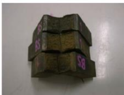
รูปที่ 2.14 ลักษณะพื้นที่รอยแตกแบบเปราะ และแบบเหนียวในการทดสอบแรงกระแทก [19]
