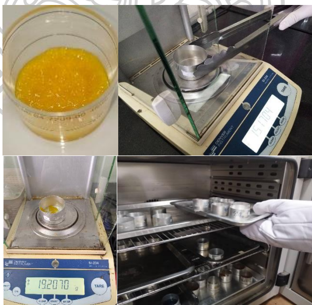
ภาพที่ 18 การเตรียมตัวอย่างและการวิเคราะห์ปริมาณความชื้น
