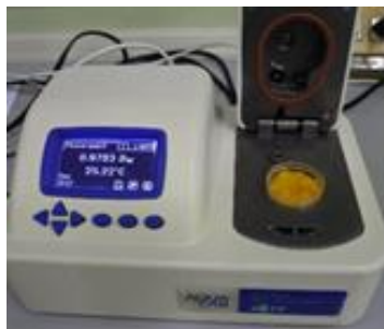
ภาพที่ 19 ขั้นตอนการวิเคราะห์หาค่าวอเตอร์แอกติวิตี้
