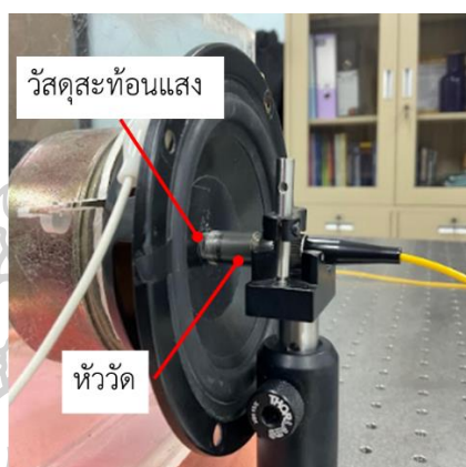
รูปที่ 3.8 ตัวอย่างการติดตั้งทดสอบการสะท้อนแสงกับหัววัด FFPI
