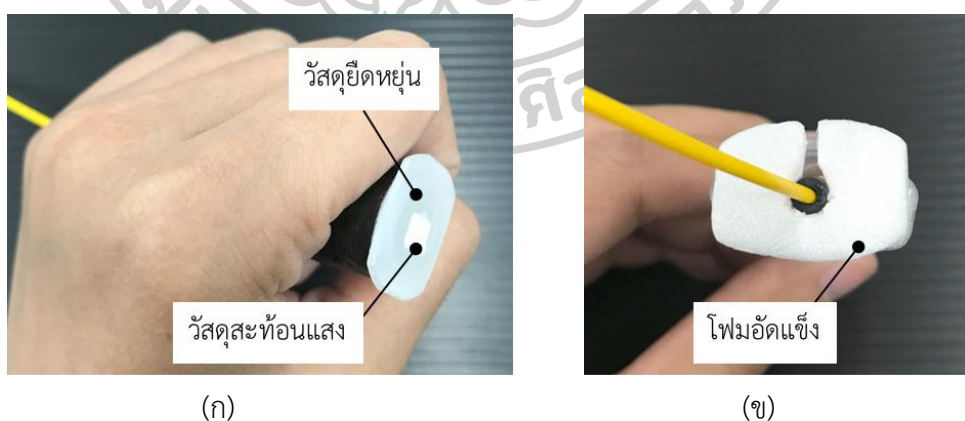
รูปที่ 4.3 หัววัดที่พัฒนาขึ้น; (ก) ลักษณะหัววัดส่วนต้น และ (ข) ลักษณะหัววัดส่วนปลาย
