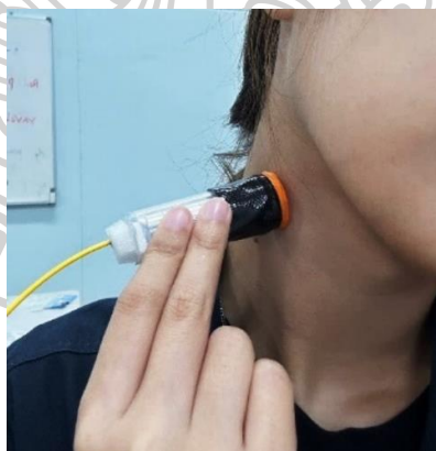
รูปที่ 4.10 หัววัด FFPI บริเวณลำคอด้านขวา
