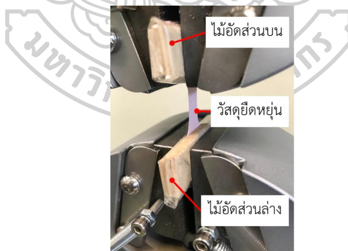
รูปที่ 3.12 นำเข้าชิ้นส่วนทดสอบวัสดุยืดหยุ่นเข้าเครื่องดึง
