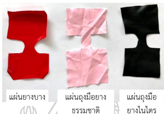
รูปที่ 3.11 ผลการตัดชิ้นส่วนตัวอย่างของวัสดุแต่ละชนิด
