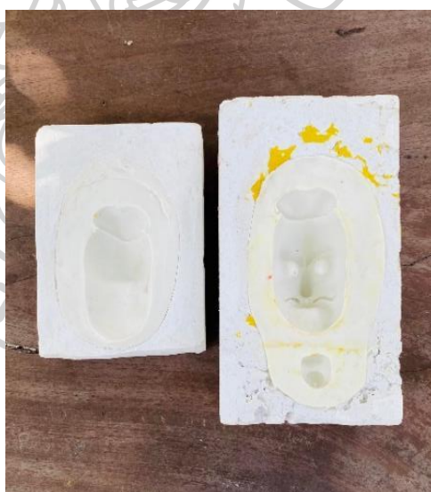
ภาพที่ 211 ภาพแม่พิมพ์ยางซิลิโคนและพิมพ์ปูนพลาสติกสำหรับเตรียมการหล่อ
