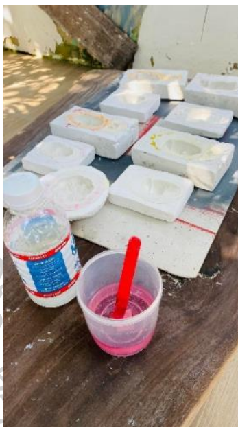
ภาพที่ 212 ภาพการเตรียมแม่พิมพ์สำหรับการหล่อศิระะ
