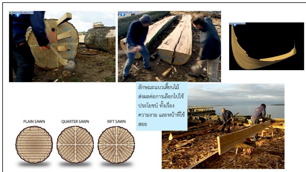
ภาพที่ 129 การแบ่งไม้ตามแนวเส้นไม้ที่อธิบายถึงองค์ความรู้เรื่องคุณลักษณะของไม้ เพื่อสร้างวัสดุที่มีคุณสมบัติเชิงกลที่ตรงต่อความต้องการ ที่มา : https://www.youtube.com/watch?v=bc1T5yVFsgE
