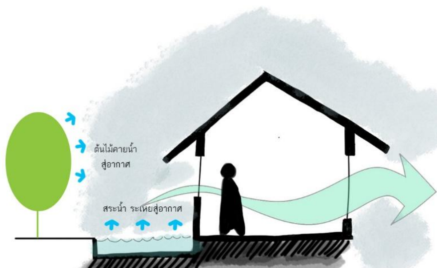
ภาพที่ 39 การระบายความร้อนออกจากอาคารด้วยวิธีระเหยกลายเป็นไอ
