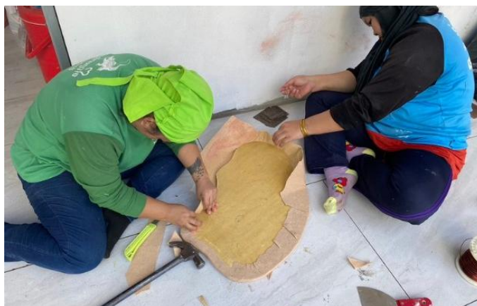
ภาพที่ 21 การติดตั้งวัสดุประเภททองแดงเข้ากับพื้นผิวไม้
