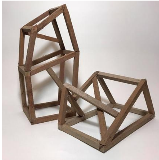
ภาพที่ 7 ต้นแบบโครงสร้างศาลโดยสลักไม้ไปมา
