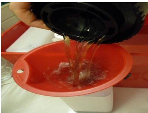
ภาพที่ 31 การเทน้ำยา CD ลงแหงค์ล้างฟิล์ม
