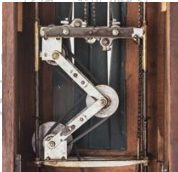
ภาพที่ 20 กลไกภายในแก้วน้ำวัดตัวแรกของโลก ที่มา : fujiiryoki (2567)
