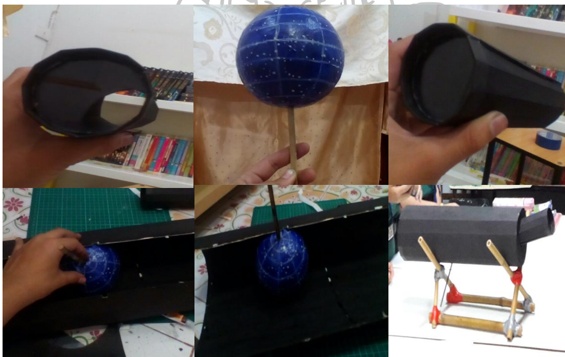
ภาพที่ 11 ส่วนประกอบของนวัตกรรม Global Star Chart Telescope
