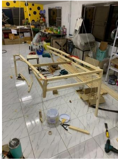
ภาพที่ 40 ขั้นตอน 3.6.2 นำไม้ที่ตัดมาประกอบตามแบบที่กำหนดโดยมีการทากาวติดไม้และหนีบไม้ เพื่อให้แน่น ที่มา อัมพล ดอนแหยม
