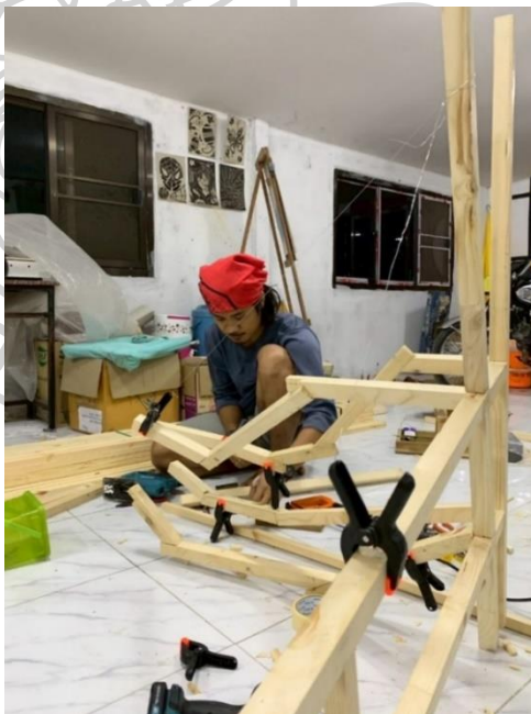
ภาพที่ 24 ขั้นตอน 3.6.2 นำไม้ที่ตัดมาประกอบตามแบบที่กำหนดโดยมีการทากาวติดไม้และหนีบไม้เพื่อให้แน่น ที่มา อำพล ดอนแหยม
