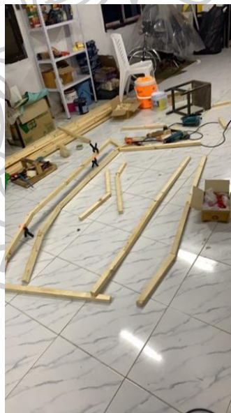
ภาพที่ 39 ขั้นตอน 3.6.1 วัดสัดส่วนของไม้ที่นำมาใช้ขยายในงานตามที่กำหนดตัดตามขนาดต่างๆ ต่างออกไปตามที่กำหนด ที่มา อำพล ดอนแหยม
