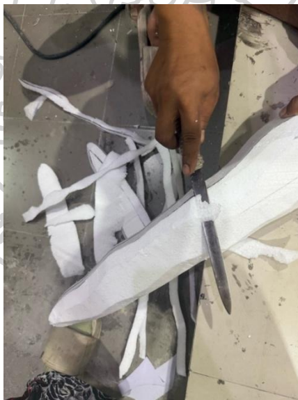
ภาพที่ 41 ขั้นตอนที่ 7.8 เกลาโฟมให้เป็นรูปลิ้น แล้วทายางพาราหลายๆ ชั้นลงบนตัวต้นแบบ
