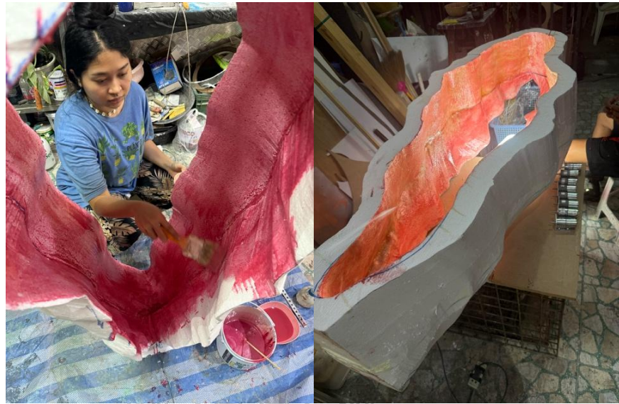
ภาพที่ 38 ขั้นตอนที่ 7.5 ทาเรซินเคลือบโฟมด้านในและซับใยแก้วในจุดที่ต้องการวางชุดมอเตอร์
