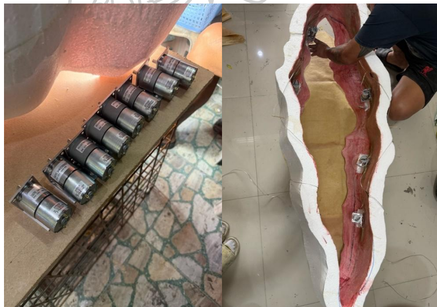
ภาพที่ 39 ขั้นตอนที่ 7.6 วางชุดมอเตอร์เกียร์ DC 12V รอบ 15-30(PRM) ขนาดเพลลา6mm. แกนเพลลายาว15mm. จากนั้นชุดโฟมให้มีความลึกพอดีในวงที่แกนเพลลาจะหมุนได้
