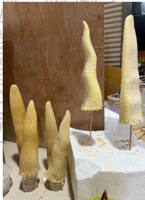
ภาพที่ 43 ขั้นตอนที่ 7.8 เกลาโฟมให้เป็นรูปล้น แล้วทายางพาราหลายๆ ชั้นลงบนตัวต้นแบบ
