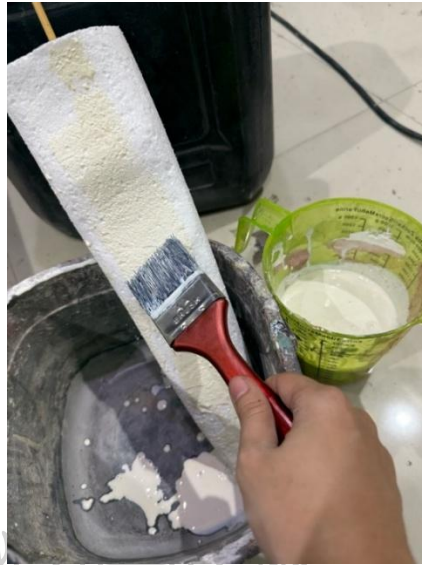
ภาพที่ 42 ขั้นตอนที่ 7.8 เกลาโฟมให้เป็นรูปล้น แล้วทายางพาราหลายๆ ชั้นลงบนตัว ต้นแบบ
