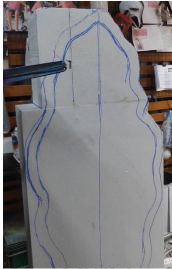
ภาพที่ 36 ขั้นตอนที่ 7.3 นำโฟมแผ่น 0.8 ปอนด์ หน้า 8 นิ้ว ขนาด 60x120 เซนติเมตร ตัดโฟม ขึ้นรูป ด้วยมีดตัดโฟมและลวดตัดโฟม ชัดเกล้าให้ได้รูปทรงตามต้องการในแต่ละชั้น
