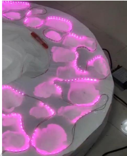
ภาพที่ 30 ขั้นตอนที่ 6.6 ผ่าโฟมครึ่งหน้าออก แล้วใส่ไฟเส้น LED Strip Light สีชมพู จากนั้นประกอบทั้งสองชิ้น หน้าหลังเข้ากลับไปทีเดิม
