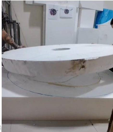
ภาพที่ 26 ขั้นตอนที่ 6.3 นำโฟมแผ่น 0.8 ปอนด์ หนา 8 นิ้ว ขนาด 60x120 เซนติเมตร มา ร่างภาพที่ต้องการเพื่อขึ้นรูปและต่อประสานโฟมด้วยโพลียูรีเทนโฟม ขาว-ดำ
